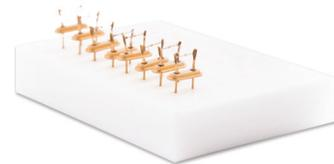
**Abbildung 2:** Eine Innenansicht der HF-QCM-Sensoren
