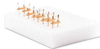
圖2：HF-QCM 傳感器的內部視圖
