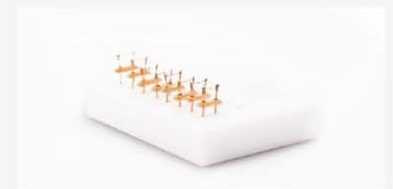
Figura 2: Vista del interior de los Sensores HF-QCM
